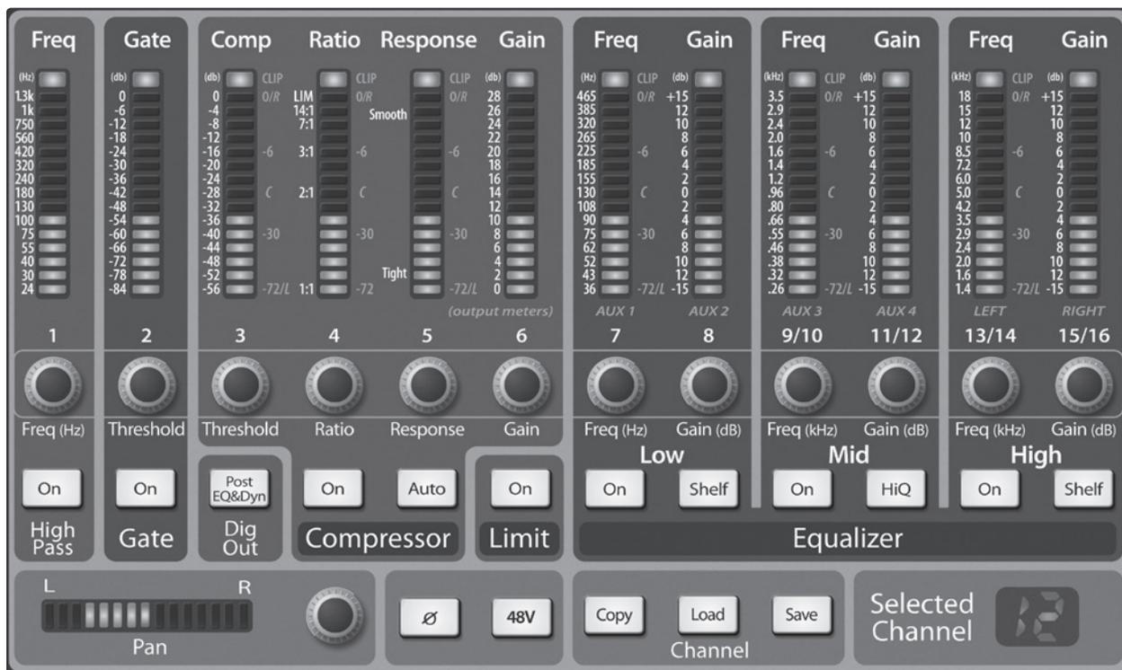
Le concept révolutionnaire de « Fat Channel » est le cœur de la StudioLive. Le Fat Channel rend accessibles à chaque entrée et sortie de la StudioLive le traitement dynamique, le routage et le panoramique par simple pression d'une touche Select. Les 12 boutons et indicateurs de niveau polyvalents du Fat Channel contrôlent quasiment tous les réglages que vous aurez besoin de faire sur votre StudioLive. Depuis le Fat Channel, vous pouvez :
