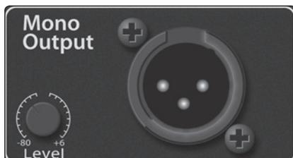
**Sortie mono (Mono Output).** Cette sortie symétrique produit une version mono (par sommation) du signal stéréo du bus principal.
