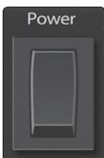
**Interrupteur d'alimentation.** Poussez la partie supérieure de l'interrupteur ( | ) pour allumer votre StudioLive. Poussez la partie inférieure de l'interrupteur ( O ) pour l'éteindre.
