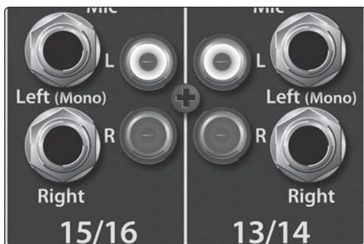
Les voies 13/14 et 15/16 ont des connexions RCA asymétriques en plus des connexions jack 6,35 mm 3 points (TRS) symétriques. Comme pour les prises jack, une entrée RCA de droite ne sera pas accessible sur la table de mixage si les voies ne sont pas couplées.
