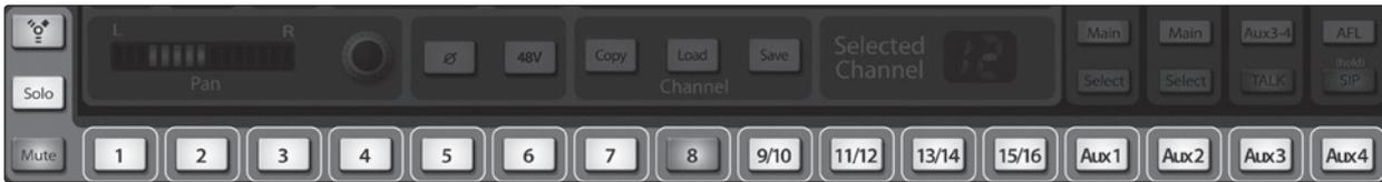
Chaque voie et Aux de la StudioLive 16.0.2 possède une touche multimode. Ces touches vous permettent de mettre en solo ou de réduire au silence une voie ou un Aux, ainsi que de mettre en service les retours FireWire de la voie.
