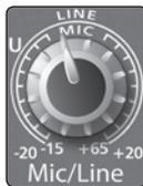
**Commande de compensation de niveau.** Règle le niveau de gain d'entrée. La commande de compensation de niveau règle le gain de l'entrée analogique de la voie. Il est très important de correctement régler cette commande afin de minimiser le bruit et d'éviter les distorsions par saturation.
