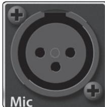
**Entrées microphone.** Votre StudioLive est équipée de 12 préamplificateurs de microphone XMAX PreSonus pour l'emploi avec tous les types de microphones. Le préamplificateur XMAX possède un buffer d'entrée de classe A suivi d'un étage de gain à double asservissement. Cet arrangement donne un bruit ultra faible et un large contrôle de gain permettant d'amplifier les signaux souhaitables sans augmenter le bruit de fond indésirable.
