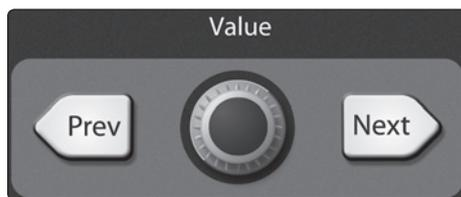
Utilisez les **touches Next** et **Prev** pour naviguer dans l'écran. Pour changer un paramètre, utilisez l'**encodeur Value** (valeur) situé directement sous l'écran LCD. La couleur s'inversera pour chaque paramètre sélectionné en vue de modification.
