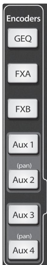
Les **touches de mode d'encodeurs** (Encoders) situées sur la gauche du Fat Channel servent à cela. Chacune de ces touches vous permet de voir et de régler le niveau de départ de chaque voie vers ce mixage Aux ou mixage d'effet.
