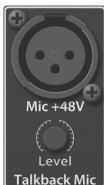
**Entrée de micro de réseau d'ordres (Talkback Mic).** La StudioLive n'a pas de micro de réseau d'ordres intégré, un micro externe doit être utilisé. L'alimentation fantôme est toujours activée sur ce préampli micro, aussi pouvez-vous utiliser un microphone dynamique ou à condensateur.
