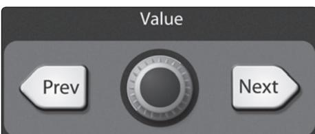
Avec les **touches Next et Prev**, naviguez jusqu'aux champs de niveau de sortie (Output Levels) pour FXA, FXB et Main (généraux) et réglez pour chacun le numéro de message de changement de commande (CC) que vous souhaitez utiliser afin de contrôler le volume de sortie de chaque bus. Vous pouvez choisir n'importe quelle valeur de 0 à 127.
