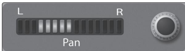
La **commande Pan** de chaque entrée ou bus de sortie se règle dans le Fat Channel. L'afficheur à DEL représente le réglage de panoramique et l'encodeur à droite de l'afficheur contrôle le panoramique pour l'entrée ou le bus de sortie sélectionné. Quand deux canaux sont couplés en une paire stéréo, l'affichage à
