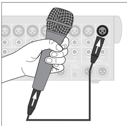
1. Prenez un microphone et un câble de micro et branchez-le dans l'entrée micro du canal 1 de la StudioLive.
